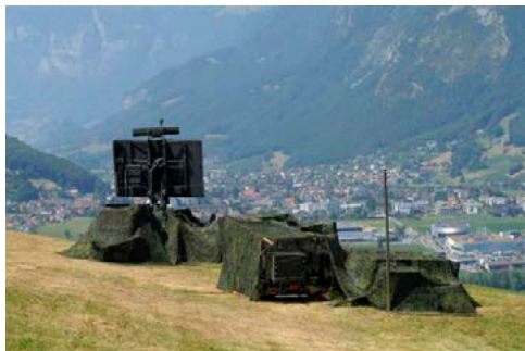
Le radar tactique d'aviation (TAFLIR) des Forces aériennes surveille l'espace aérien inférieur
