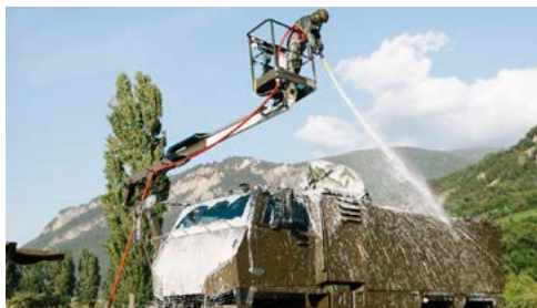
Décontamination NBC de gros véhicules
